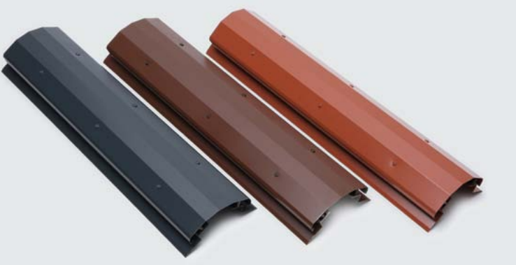
Metalllüfterfirst Lüftungsquerschnitt von 380 cm 2 per lfm First/Grat. Die Decklänge beträgt 1,00 lfm. Für alle Dächer mit Unterdach eine ideale Lösung.
